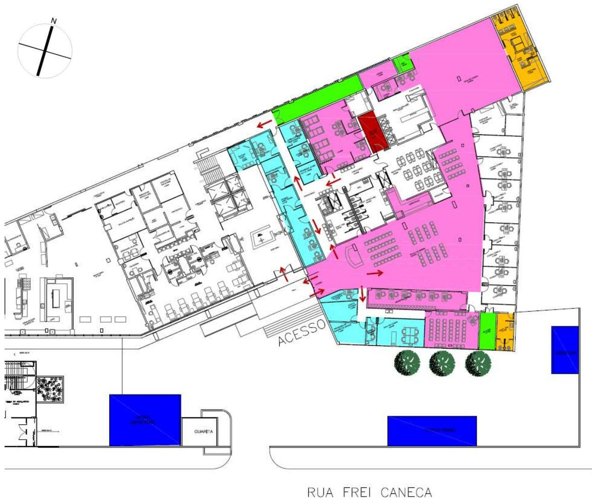
Figura 75: Planta Baixa do Térreo existente, com marcação das áreas para intervenção
